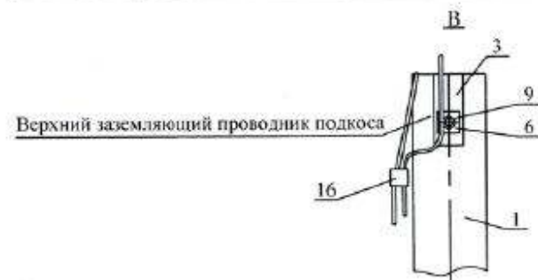
Схема 1 установки на ВЛЗ А10МИ-1 в качестве анкерной опоры
