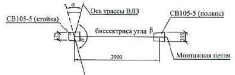
Схема установки стойки и подкоса
