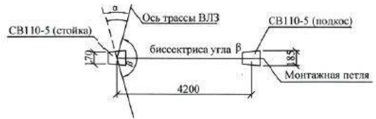
Схема установки стойки и подкоса
