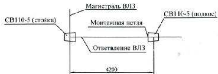
Схема установки стойки и подкоса
