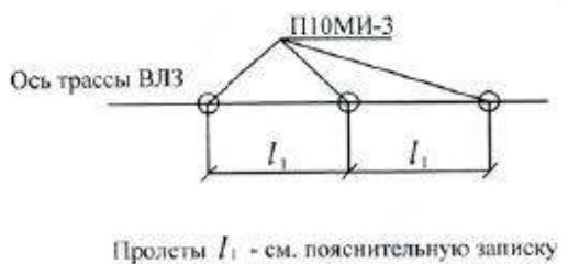
Схема установки промежуточных опор на ВЛ
