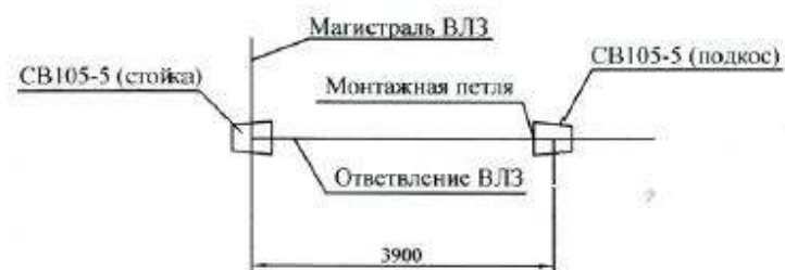
Схема установки стойки и подкоса
