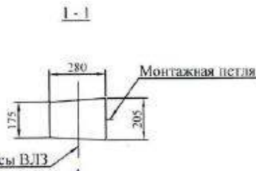
Схема установки стойки опоры
